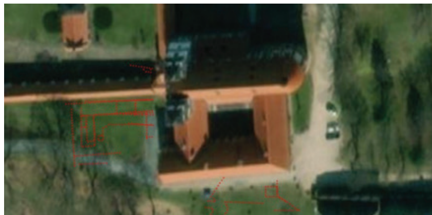
3 pav. Georadaru matomos anomalijos nuo 60 cm iki 280 cm gylyje (pažymėtos raudonomis taškinėmis linijomis), 2024.
